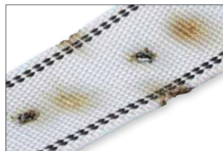
Forte sollecitazione termica, segni di bruciatura, schizzi di saldatura, ecc.
