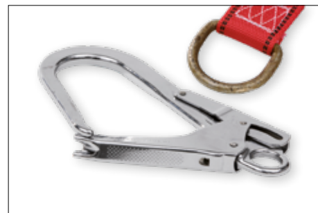
Elementi metallici deformati e/o corrosivi
